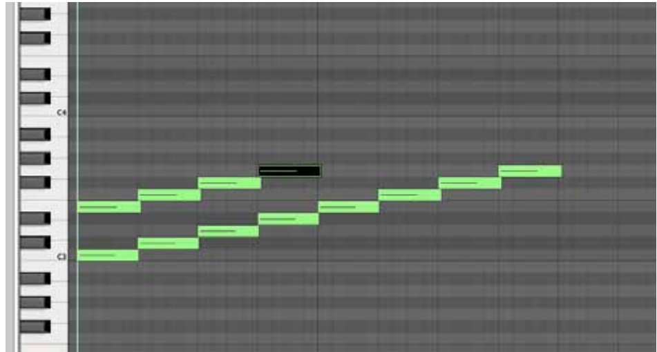
Abbildung 1: Möglichkeiten der Tonerzeugung in einer herkömmlichen Sequenzer-Software. Der MIDI-Standard und die ästhetische Ausrichtung des Programms verhindern die Modifikation der von der Klaviatur und der temperierten Stimmung vorgegebenen Tonhöhen. Mikrotongales Komponieren ist in einer solchen Umgebung nicht möglich.
